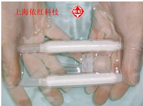
图 31 圆柱体 0.2MPa 气压水中无泄漏
