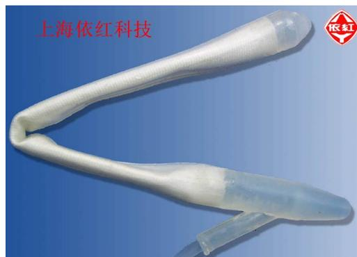
图 34 圆柱体三万次屈挠后没有裂纹
