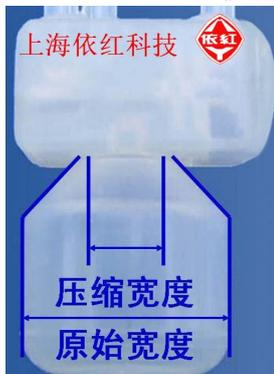
图 33 液泵阀 50 万次压缩测试没有故障
