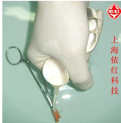
图 30 液囊水中反复挤捏 10 次以上检测耐压
